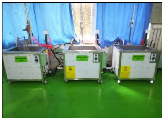
超音波洗浄装置 庫内寸法650×500×500
