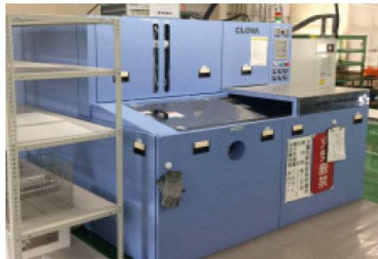
真空洗浄乾燥機 槽内W600×D400×H300
